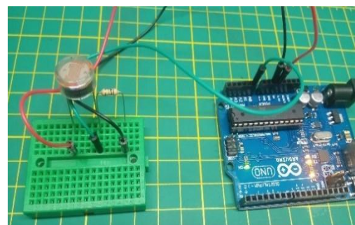
Schemat układu na Tinkercad i zdjęcie montażu układu (LDR))
